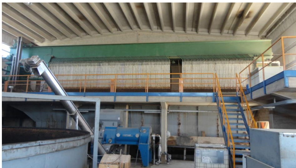
Foto n. 26: Edificio disidratazione meccanica-essiccamento termico: filtropressa a piastre
