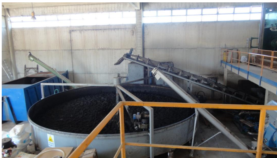
Foto n. 27: Edificio disidratazione meccanica-essiccamento termico: vasca accumulo fanghi
